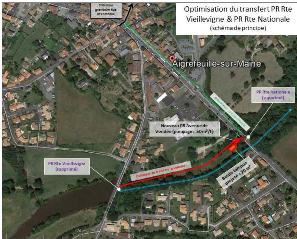
**Fig. 5. Schéma de principe des aménagements : PR Avenue de Vendée**
